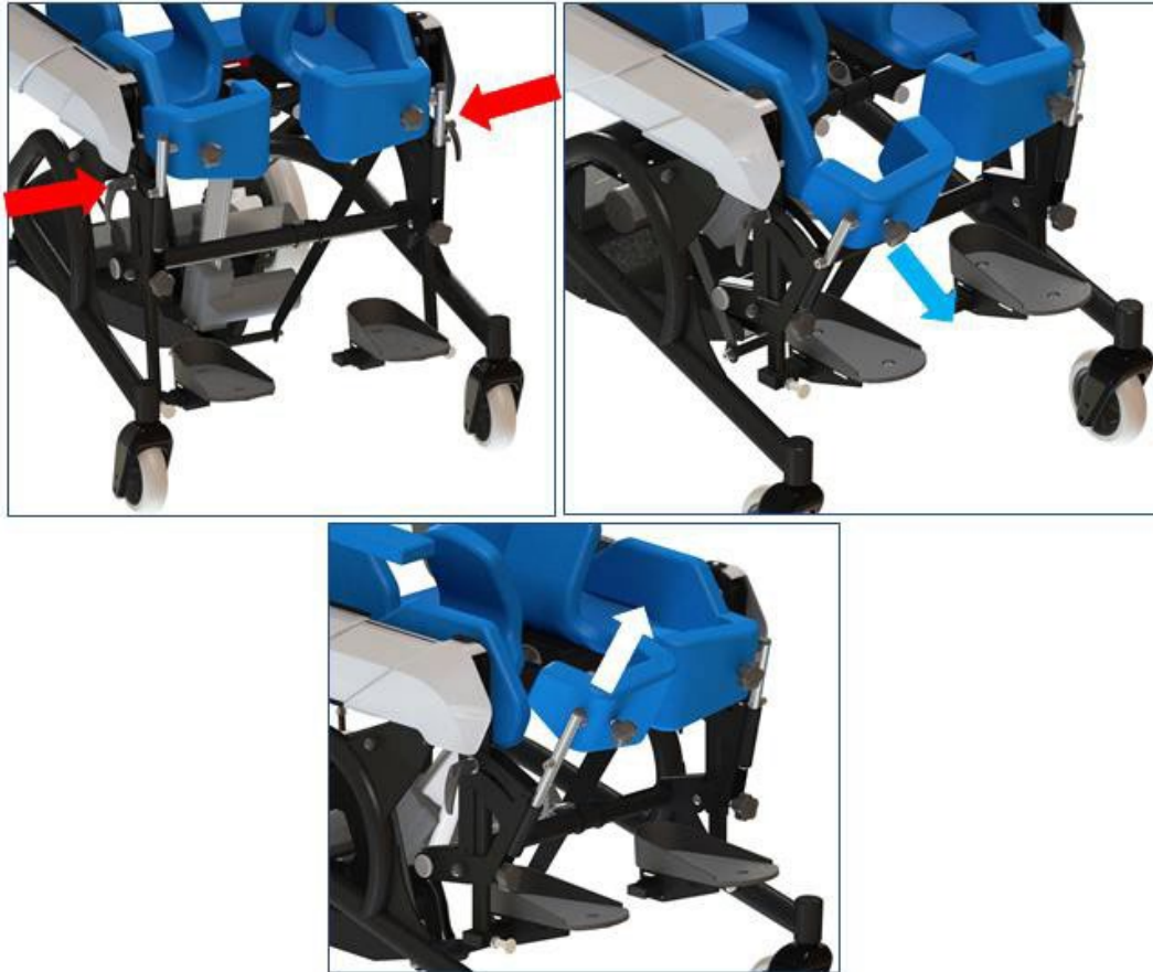
Abb. 20: Abbinden und Schließen der Kniebandagen
