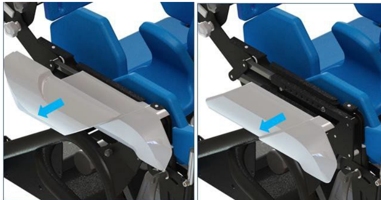
Abb. 7: Abtragssequenz der Kunststoffabdeckungen
